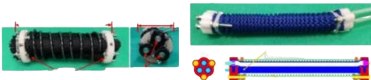
Рисунок 1.5 – Скользящий механизм с использованием трех EFPA.
