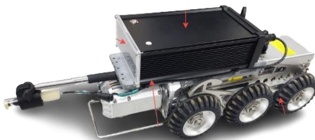
Рисунок 1.1 – Простой 6-колесный робот для горизонтального продвижения.
