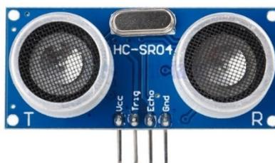
Рисунок 2.4 – Ультразвуковой датчик HC-SR04
